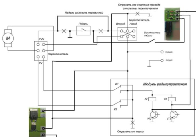
Рисунок 2. МПС с модулем согласования. Схема подключения.
