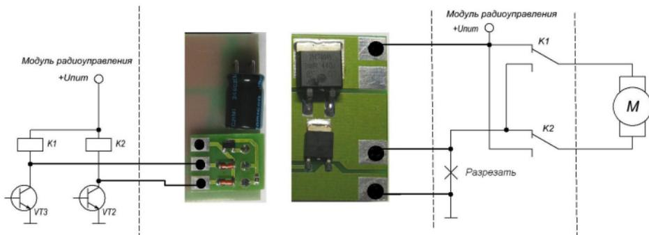
Рисунок 1. МПС с модулем согласования. Схема подключения.
